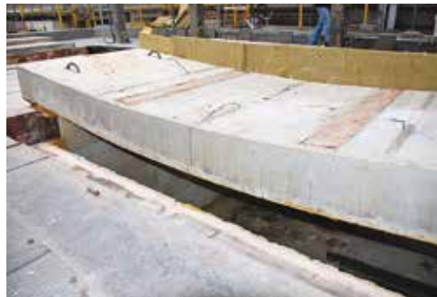
Deformovaný železobetonový vzorek stropní desky po zkoušce zatížením při požáru
