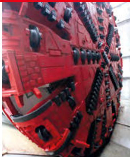
Razicí štit TBM Tunnel Boring Machine
